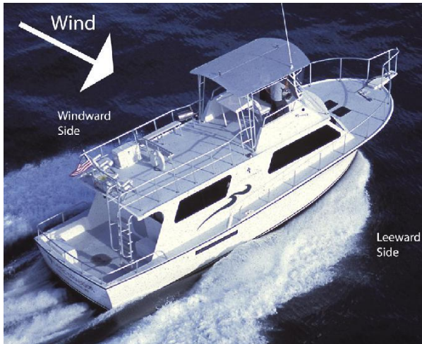
Рисунок 1-93 Наветренная и подветренная стороны моторного судна (WINDWARD & LEEWARD - POWER)
