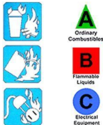
Рисунок 3-7 Классификация видов возгорания (FIRE RATING SYSTEM)
